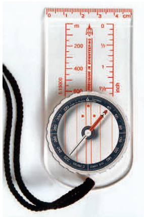
Рис. 2 Компас «на плате»
